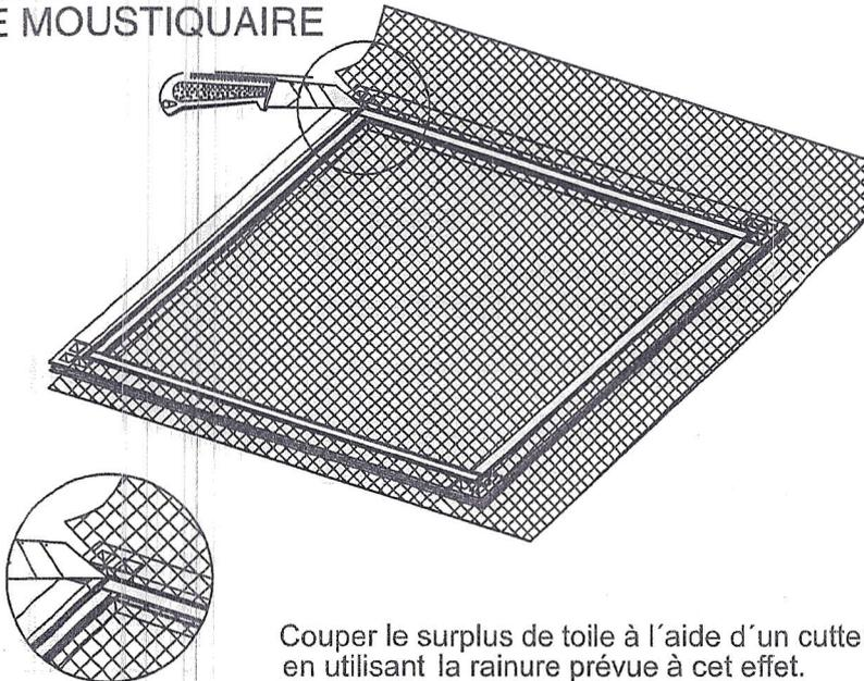
Couper le surplus de toile à l'aide d'un cutter en utilisant la rainure prévue à cet effet.
