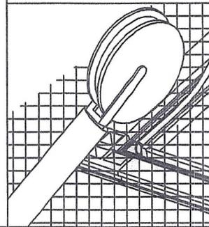
Découper le jonc néoprène à la dimension des profils et l'introduire avec une roulette ou les doigts entre la toile moustiquaire et les profils aluminium. Tendre la toile.
