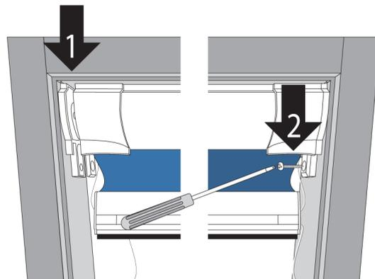
2. Après avoir repéré leur position à l'aide du boîtier, fixer les embouts de part et d'autre à l'aide des vis à tête fraisée fournies.
